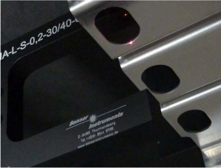
Zımbalama parçasının FIA-L-RL çatal ışık bariyeri vasıtasıyla hassas konumlandırılması
